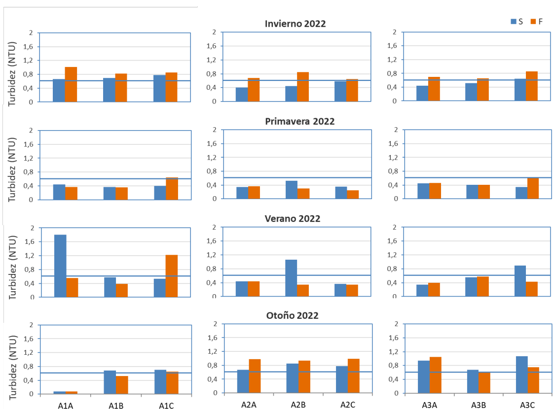
Figura 4.12. Distribución de la turbidez en el entorno del vertido, en superficie (S) y fondo (F). En línea continua azul se indica el valor medio anual (datos de las 4 campañas).
