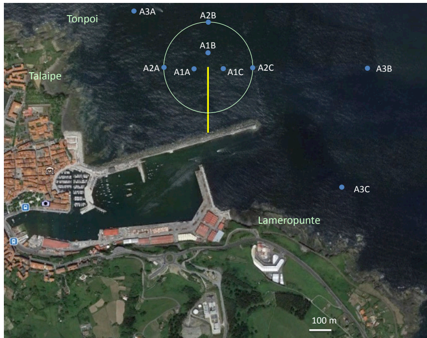
Figura 4.3. Situación de las estaciones de muestreo de calidad de aguas en el entorno de los vertidos de la EDAR de Lamiaran.
